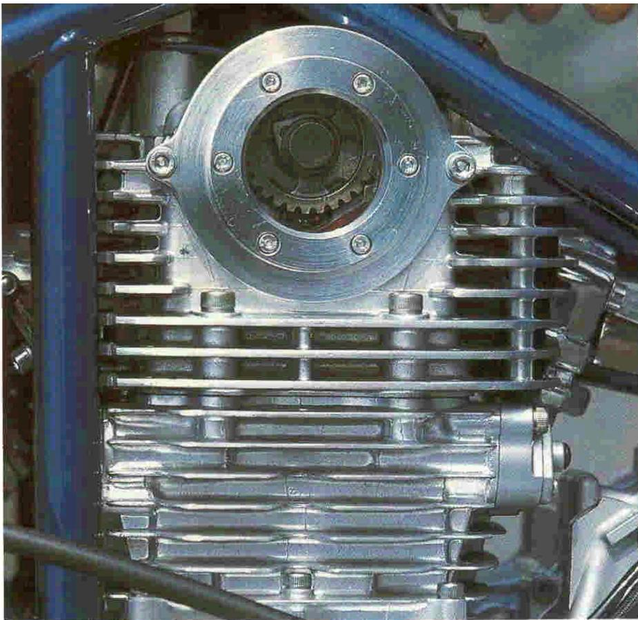
**Sauberes Handwerk: Nockenwellen-Bullauge und gekappte Kühlrippen am hinteren Zylinder**
