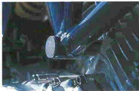
Mittlere Motorhalterung: die Chrom-Abdeckkappe wird innen per O-Ring abgedichtet
