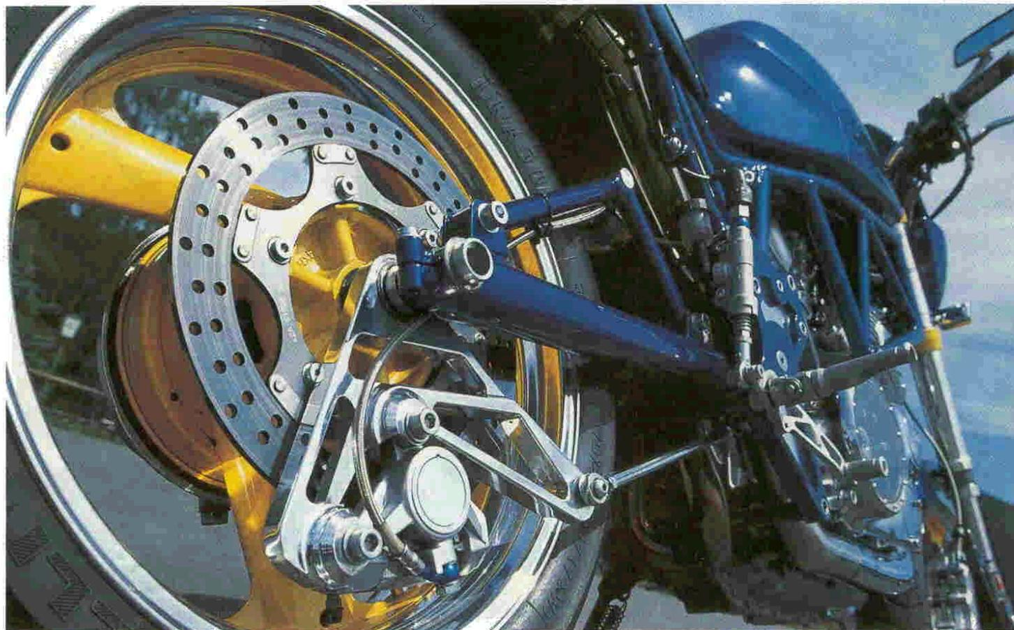
**Schön und funktionell: Der Anker der kunstvoll gefrästen Bremsaufnahme wird am Rahmen abgestützt und sorgt für einen Pro-Dive-Effekt**
