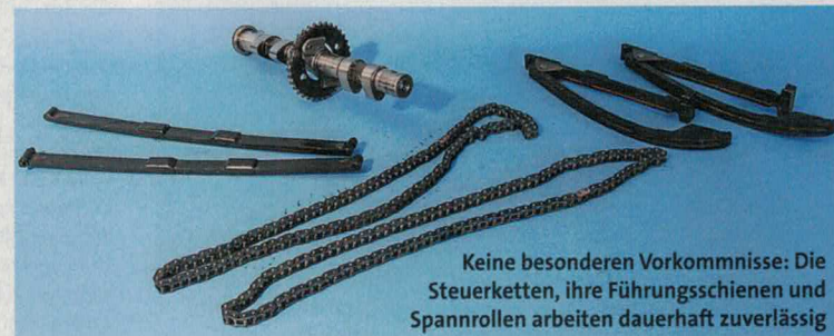
Typische Schwachstellen kennt der Ventiltrieb nicht. Bei fortgeschrittenem Verschleiß bereitet freilich der...
