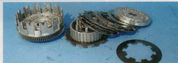
Der Herausforderung der V4-Power gewachsen: die Kraftübertragung. An den Mitnehmern des zweiten Gangrads ist Verschleiß am ehesten zu beobachten. Vor der Kurbelwelle zu sehen: die Ausgleichswelle
