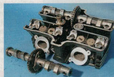
Typische Schwachstellen kennt der Ventiltrieb nicht. Bei fortgeschrittenem Verschleiß bereitet freilich der...
