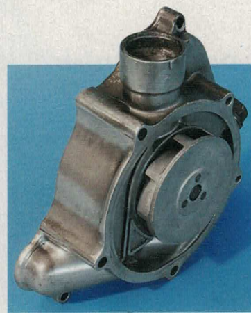
Unauffälliger Arbeiter: die von der Ausgleichswelle angetriebene Wasserpumpe
