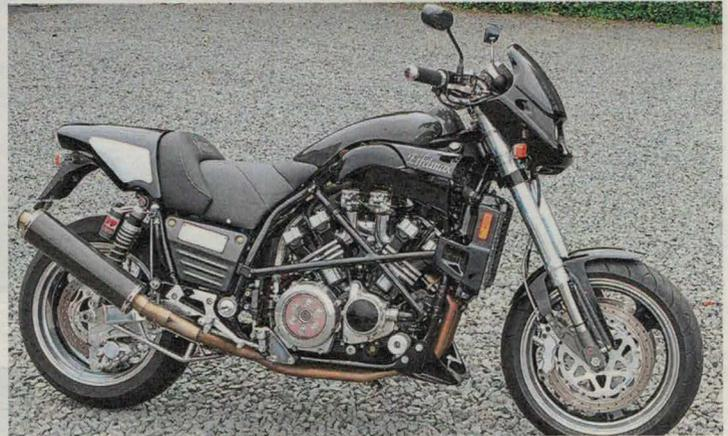
Eifelmax mit Tuning an V4 und Fahrwerk samt Rahmenverstärkung
