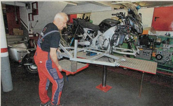
Werkstatt: drehbare Bühnen mit Unterflurtechnik, Gespannrahmen
