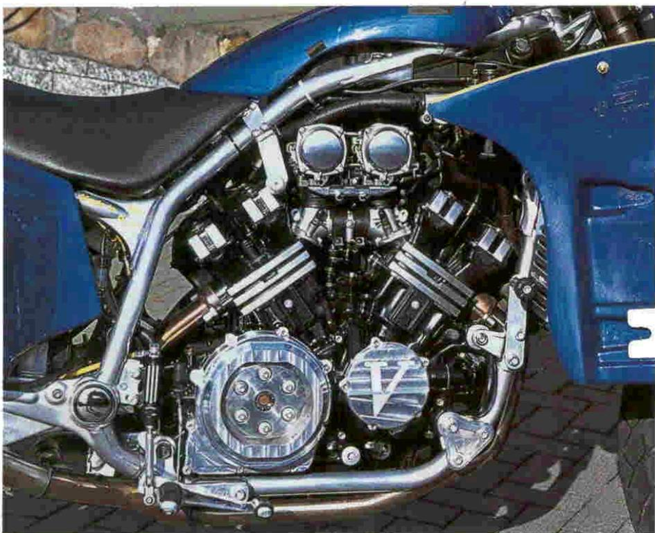
**Powerklotz mit 150 PS: Der auf 1,5 Liter aufgebohrte V4 der Maxduro zieht urgewaltig durch**
